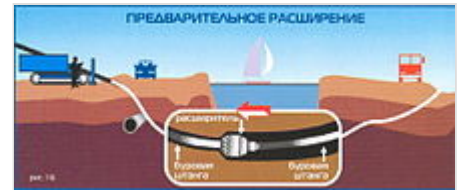
Backreamer mit dem einzuziehenden Rohr
