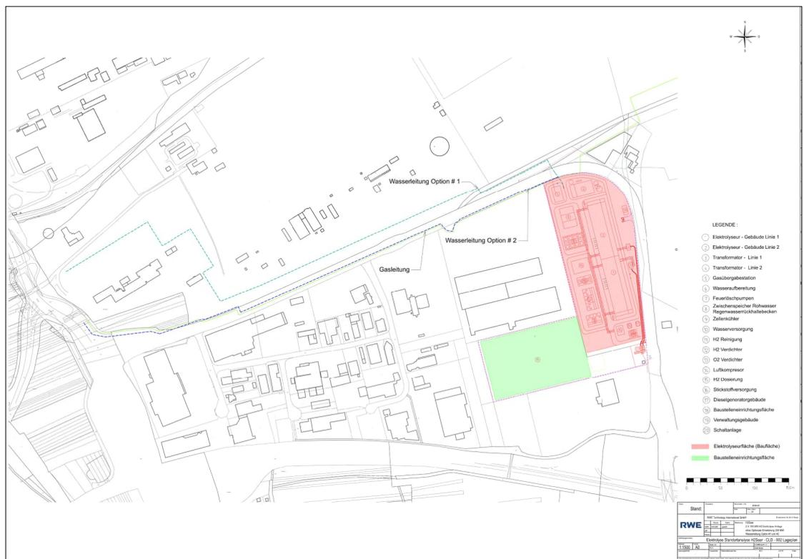
**Abbildung 5.** Lageplan Wasserleitungen und Gasleitung Creos Deutschland GmbH mit Standort Wasserstofferzeugungsanlage.
